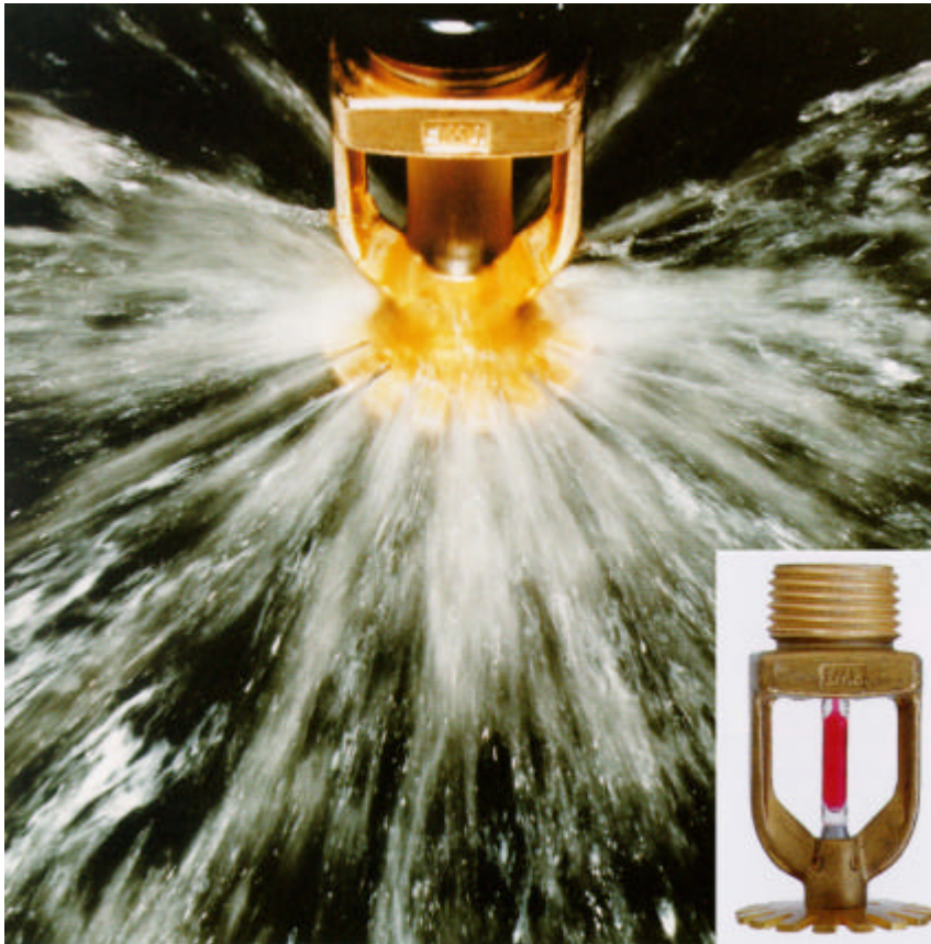
Bild 3: Sprinklerdüsen lösen bei Ueberschreitung einer definierten Temperatur aus und versprühen pro Minute 60 bis 100 Liter Wasser unmittelbar über dem Brandherd.
